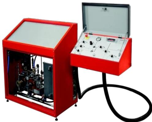
Установки серии **HPU-sep** рекомендуется применять везде, где необходимо провести испытания высоким давлением.
